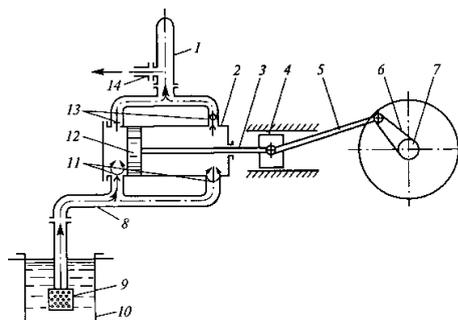
Рисунок 1 - Схема работы двухцилиндрового бурового насоса:
