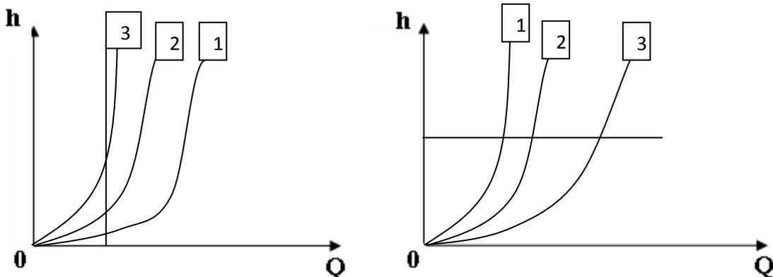
Рис. 2 Последовательное и параллельное соединение участков труб
