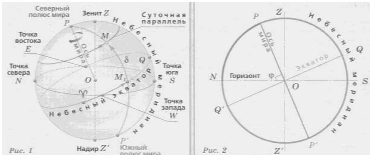
Прямая линия, которая совпадает в данной точке с направлением действия силы тяжести, называется *отвесной линией*. Направление отвесной линии можно определить с помощью простейшего отвеса – грузика на тонкой нити. Отвесная линия пересекает небесную сферу в двух точках: верхняя (над головой наблюдателя)  $Z$  называется *зенитом*, нижняя  $Z'$  – *надиром* (см. рис. 1).
